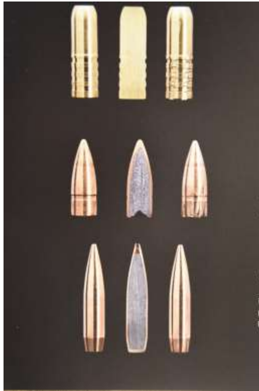
FOTO 8) Varie tipologie di palle sezionate: dall'alto palla monolitica, al centro palla bicomponente, in basso palla bicomponente espansiva con foro sull'apice
